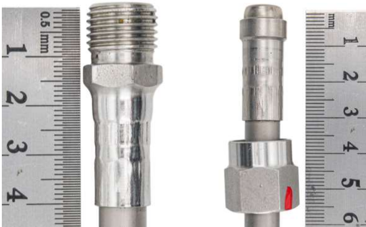
Рис. 3. Вид ниппелей с обоих концов трубопровода с указанием их размеров.
